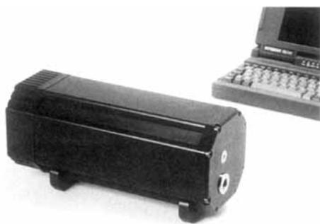
Systeme enthalten eine CCD-Kamera, die direkt in das Echelle-Spektrometer integriert ist.
