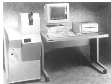
Optimierung der Massengenauigkeit erfolgt durch die Ionenoptik des Systems. Die Fokussierung der Repeller-Geometrie verbessert die Systemempfindlichkeit. Ein Sekundärionengenerator erhöht die Konvertierungseffizienz, wodurch die Signalverstärkung für größere Ionen erhöht wird.
