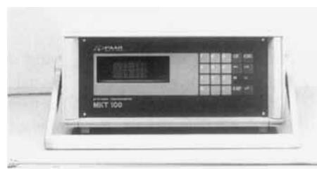
stellen unter Verzicht auf Näherungsverfahren aus dem elektrischen Widerstand über die Referenz- und Abweichungsfunktionen der Internationalen Temperaturskala von 1990 berechnet. Das MKT 100 ist in Verbindung mit Platin-Widerstandsthermometern Pt 100 für den rauen Einsatz in der Industrie und im Labor zur Kalibrierung von Temperaturmeßgeräten bestimmt. Die Temperaturberechnung erfolgt über die Funktionen der DIN IEC 751.
