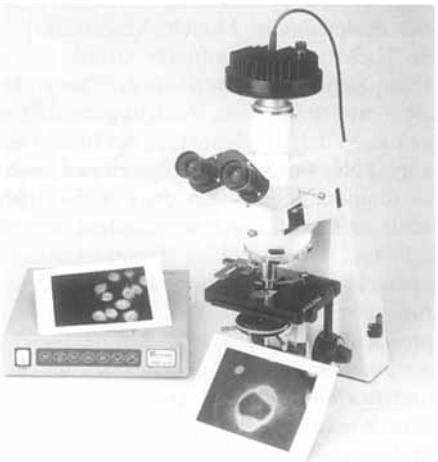
Kamera, die ohne Computer kontrastreiche Bilder vermittelt als handelsübliche TV-CCD-Kameras. Durch Kühlung lassen sich Integrationszeiten bis zu vier Minuten erreichen. Diffuse Abbildungen werden durch den Bildverarbeitungsprozessor bezüglich der Schärfe, der Farbe, des Kontrasts und der Helligkeit in Echtzeit optimiert.
